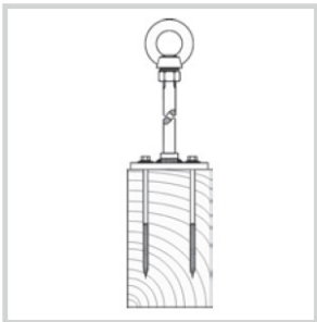
Schrauben in Holzsparren (kleine Grundplatte, mit vier Schrauben)
