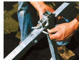
Stecker zum Hochklappen des Auslegers zur Lagerung
